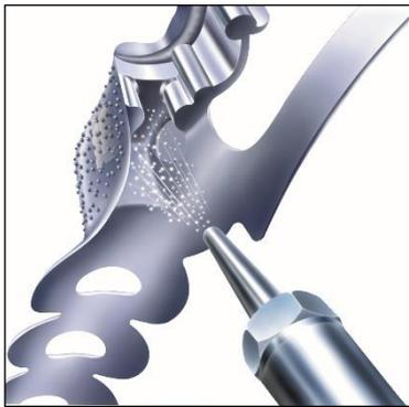
Prima di incollare sabbare l'interno dello scheletrato usando l'ossido di alluminio  $250\mu\text{m}$  e poi non toccare più quest'area.
