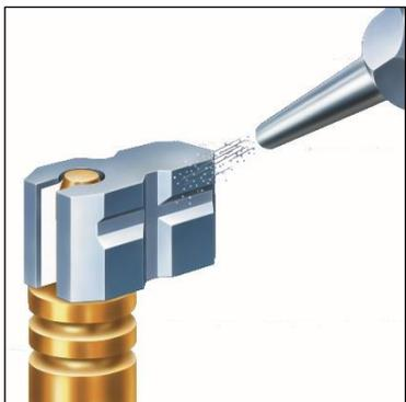
La femmina con la guaina è fissata sul supporto per la sabbatrice e sabbata con ossido di alluminio da  $110\mu\text{m}$  e una pressione di 2 bar. Non toccare più le aree sabbiate.
